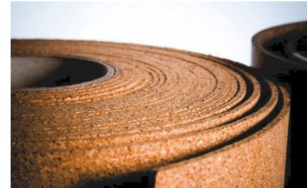
**Presovana pluta - standard** ima primenu u građevinarstvu, tapetarstvu, mašinskoj i elektro industriji. Koristi se za termo zvučnu izolaciju i antivibraciju podova, krovova, sendvič zidova, međuspratnih konstrukcija itd.
